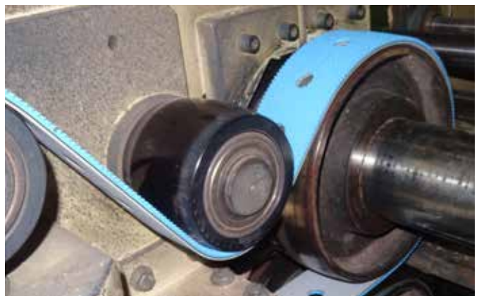
Zugträger aus Polyamidfolie bietet hohe Flexibilität und Kantenstabilität.
