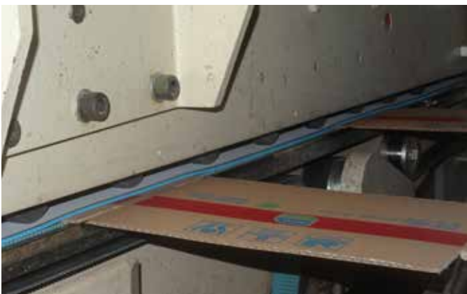
Ausgezeichnete Haftung bei Karton und höherer Ausstoß dank verschleißfester XNBR-Elastomer-Beschichtung mit P6-Struktur.
