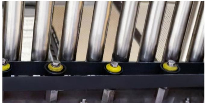
Unser Hochbelastbare Rollenanzugsriemen wurde speziell für große Lasten und lange Transportstrecken entwickelt und hält dank eines starken Zugträgers aus Aramid selbst höchsten Belastungen problemlos stand. Der Riemen ist mit einer äußerst strapazierfähigen Oberflächenbeschichtung aus Polyurethan versehen, die Staubetrieb und aufgrund ihrer bemerkenswerten Flexibilität, hohe Einsparungen hinsichtlich des Energieverbrauchs ermöglicht.
